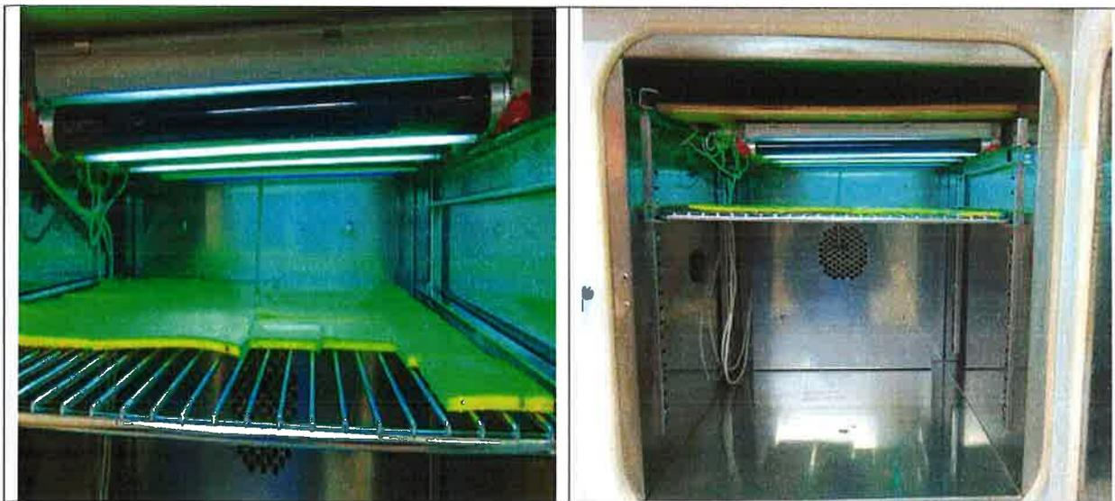
Para la obtención de las probetas, de cada butaca se cortaron 7 probetas, generándose 14 probetas totales para la evaluación del ensayo de envejecimiento acelerado. Las muestras presentaron un área de evaluación de 6x10 cm<sup>2</sup>.
